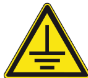
MESSA A TERRA
